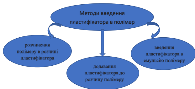
Рис. 7. Методи введення пластифікатора в полімер
